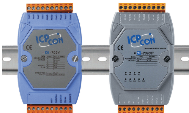
Монтаж на DIN-рейке
